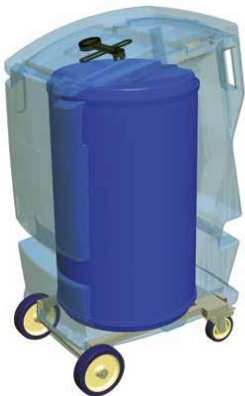
Im weigomatic® Drumtainer lassen sich Fässer ohne Hubwagen und Gabelstapler ganz leicht bewegen. Der Drumtainer ist selbst als Auffangwanne zugelassen, so dass eine extra Auffangwanne im Dosierraum entfallen kann.
