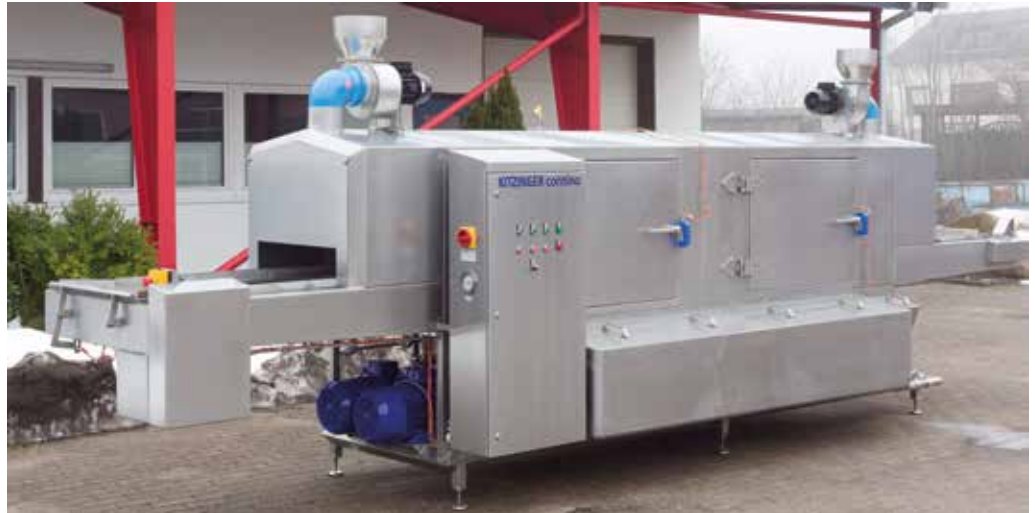
In der Kitzinger Contino 250 Durchlaufwaschanlage werden Mehrwegbehältnisse für den Transport und die Lagerung von unverpackten Lebensmitteln aufbereitet
